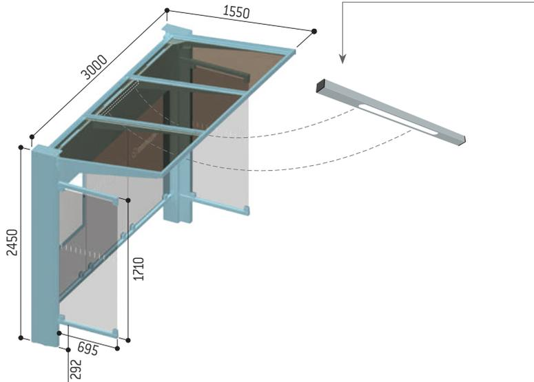
Éclairage LED par alimentation électrique 220V. Le raccordement électrique doit être assuré par un professionnel, disjoncteur non fourni 306719
